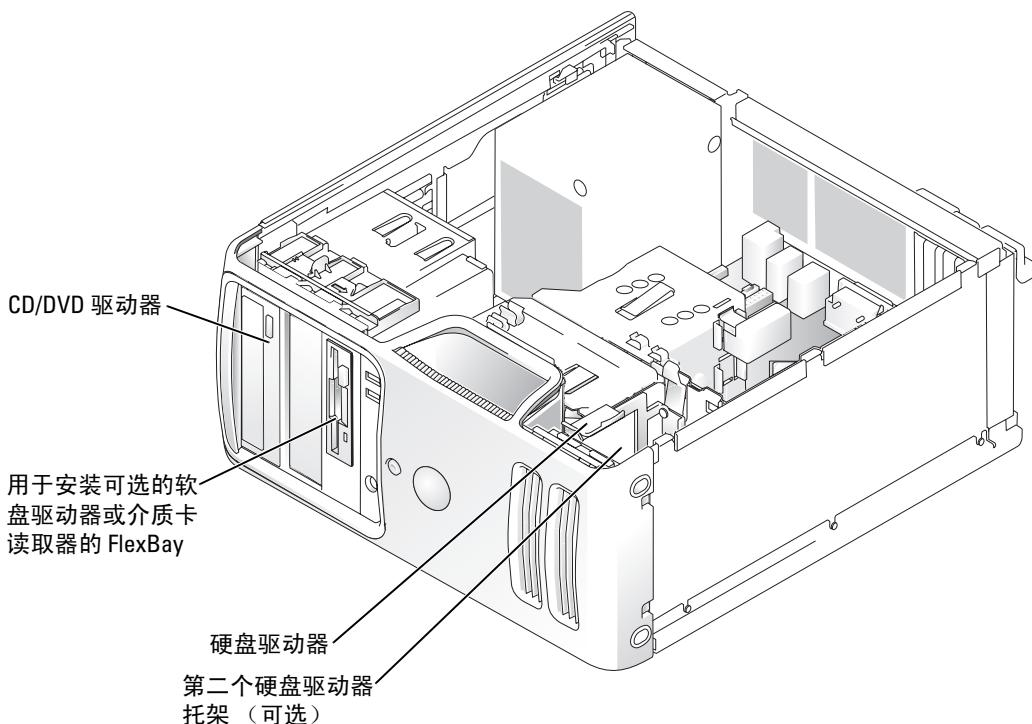
将 CD/DVD 驱动器连接至系统板上标有“IDE”的连接器。串行 ATA 硬盘驱动器应连接至系统板上标有“SATA0”或“SATA1”的连接器。
