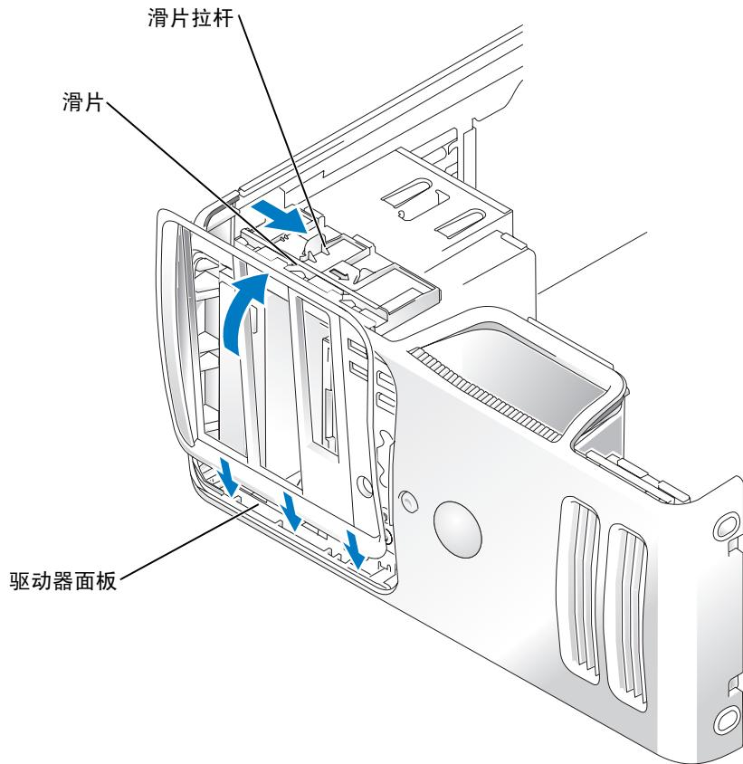
2 握住滑片拉杆并将其向计算机底座的方向推动，直至驱动器面板的卡舌松开。
