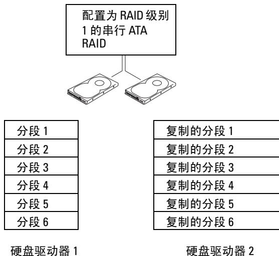
如果某个驱动器出现故障，后续的读和写操作将被定向到未出现故障的驱动器。从而可以使用未出现故障的驱动器中的数据重建备用驱动器。同时，由于数据将被复制到两个驱动器中，所以两个 120 GB RAID 级别 1 驱动器最多共有 120 GB 用于存储数据。
