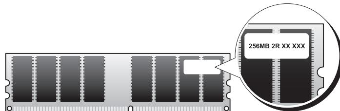
**注：**请始终按照系统板上指定的顺序安装 DDR2 内存模块。
